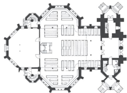
Grundriss der Bühlkirche: Durch das Kreuzen sind alle Bänke näher an der Liturgiezone
